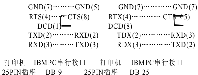
图 2-3. POS76II 打印机串行接口与PC串行口连接示意图
