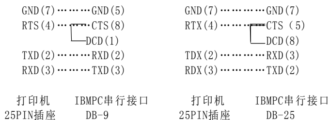
图2-4.1. 打印机串行接口与PC串行口连接示意图
