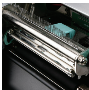
简易拆装的打印头模块
