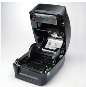
贝壳式机构设计 耗材换装更方便
